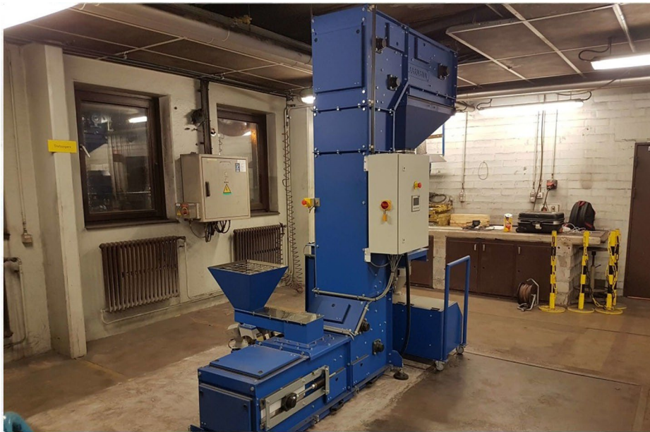
Afb 2 De ontvangstrechter is gemonteerd op een trilgoot die de bekelevator voedt
