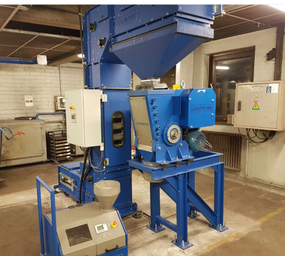
Afb. 1 De bekerelevator voedt via een wegschuifbare trechter de ondergelegen kaakbreker
